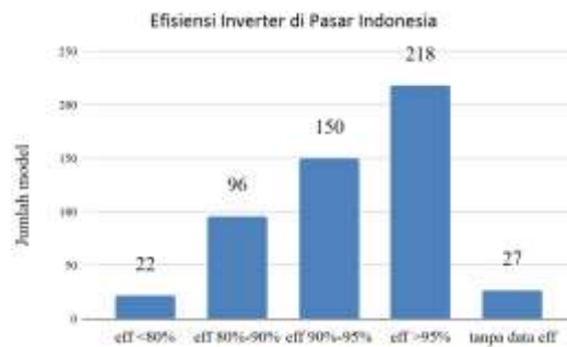
Gambar 10. Ketersediaan Inverter Berdasarkan Efisiensi Beban Penuh
