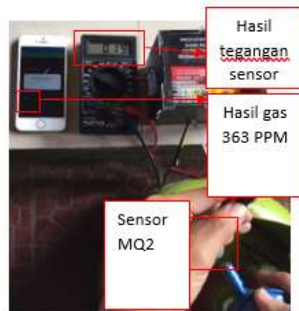
Gambar 14. Tegangan mode ringan atau kecil
