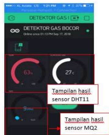
Gambar 10. Data dari Sensor DHT11 dan MQ2
