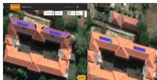
Gambar 6. Desain PLTS Skenario 3 (10 kWp)
