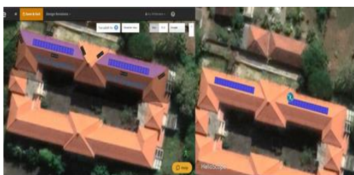
Gambar 5. Desain PLTS Skenario 2 (15 kWp)
