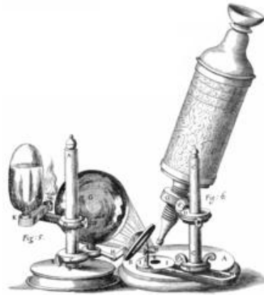
Gambar 1: Mikroskop rancangan Robert Hooke menggunakan sumber cahaya lampu minyak.
