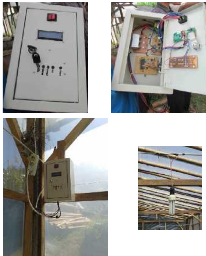
Gambar 5. Alat otomatisasi pencahayaan tanaman bunga krisan
